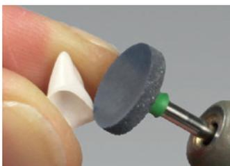
Небольшие корректуры, создание более тонкой линии края и пришлифовка контактных точек с использованием ZiLMaster Coarse.
