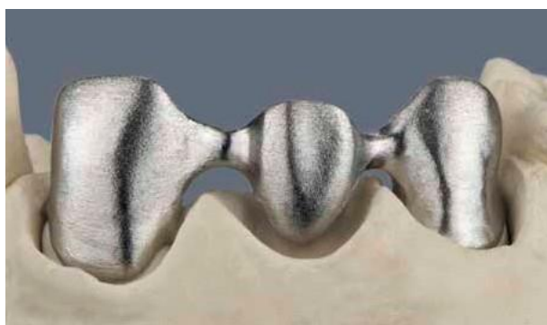
Каркас перед окислительным обжигом
