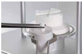
Затем поместить одноходовой поршень в горячую опоку.
