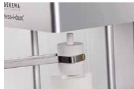
Опоку с установленными объектами поместить в центр предварительно нагретой печи для прессования.
