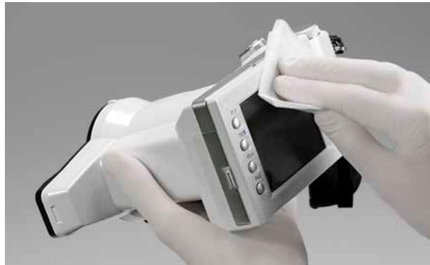
Die Kamera ist wasserresistent und kann mit Ethanol gereinigt und desinfiziert werden.
