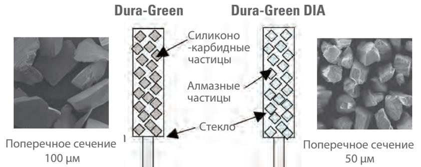
**Идеально для обработки:** цельно-циркониевых реставраций и циркониевых каркасов, дисиликата лития, оксида алюминия, прессованных и цельнокерамических конструкций, а также металлических поверхностей
