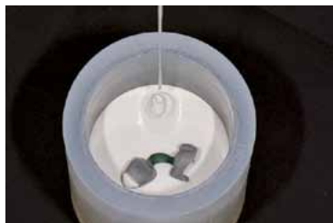
При наполнении муфеля паковочной массой избегать включения воздушных пузырьков.
