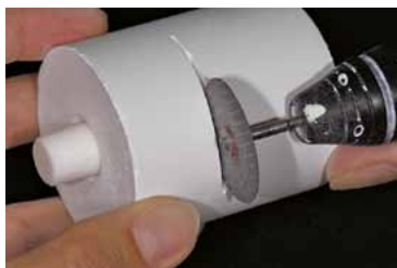
Сепарирование муфеля с помощью сепарационного диска
