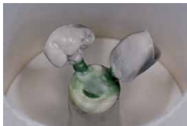
Необходимо обеспечить расстояние до внешней стенки минимум в 10 мм
