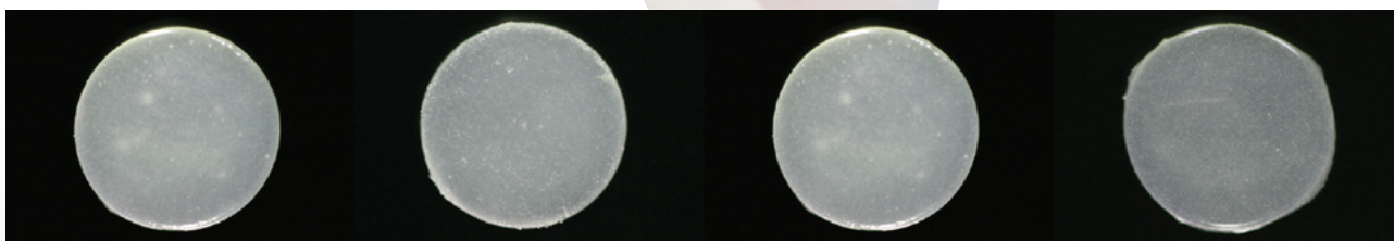
С увеличением конденсации повышается прозрачность тестовых образцов. (VinTAGE ZR T-Glass слева направо: без конденсации, ручная конденсация, ультразвуковая конденсация слабая, ультразвуковая конденсация интенсивная)
