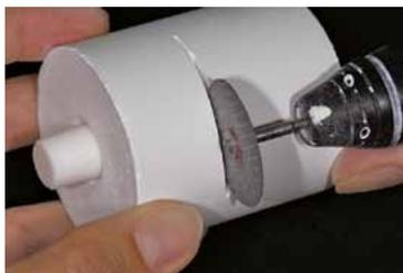
Сепарирование муфеля с помощью сепарационного диска
