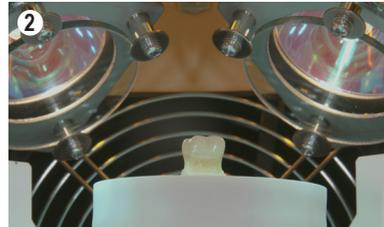
Полимеризация производится в течение одной минуты в полимеризационной камере SOLIDILITE V.
